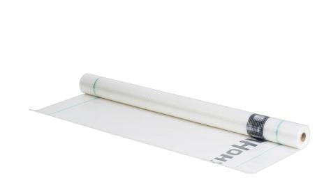
Гидро-ветроизоляция армированная ТехноНИКОЛЬ состоит из трех слоев; основного - арматурная сетка, выполненная из полиэтиленовых полос, которая с обеих сторон ламинирована полиэтиленовой пленкой. Арматурная сетка придает прочность материалу, двустороннее ламинирование обеспечивает гидроизоляционные свойства, а микроперфорация выполненная обеспечивает паропропускающие свойства.
